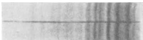
Abbild. 2. Debye-Scherrer-Diagramme von Thio-isoleucin und einem Mischkristallisat von Thio-isoleucin und Isoleucin (1:1)
